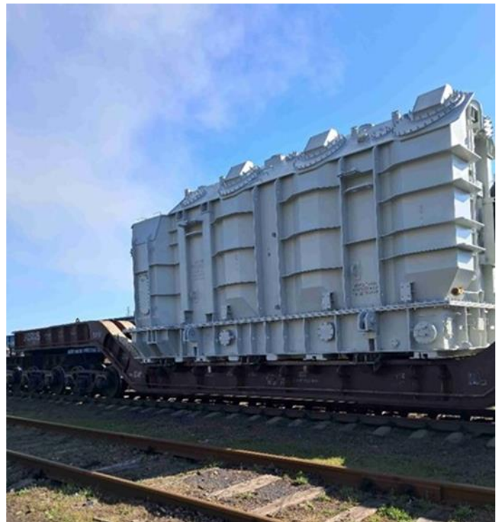
Ein Transformator während des Transports. Quelle: Mykyta Mozharovskyi / DTEK LLC
